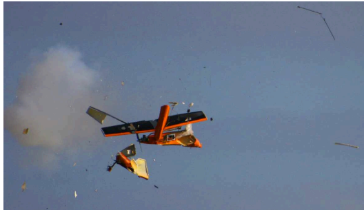
Figur: 3.38 Drone i oppløsning ved luftmålskyting
